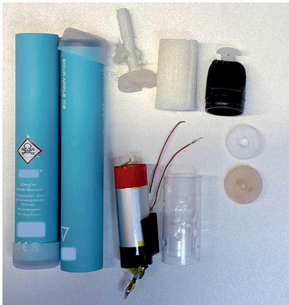
Abbildung 54: Bauteile einer Einweg-E-Zigarette
