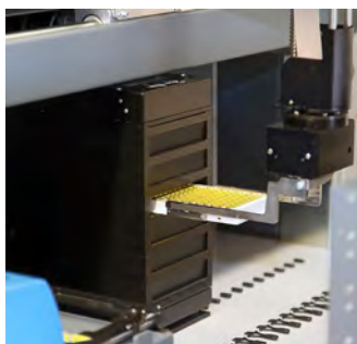
Abbildung 132 Greifarm mit exzentrischen Greiferfingern zum Beladen von Hotels, Washer und Reader
