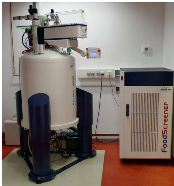
Abbildung 151 Neues 400 MHz NMR-Spektrometer am CVUA-OWL
