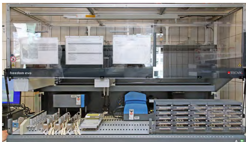
Abbildung 128 Pipettiersystem Freedom EVO® 200 als ELISA Workstation mit 8-Kanal Pipettierarm, 8 Festnadeln, 8 Spritzen 2,5 ml, Greifarm, Fast-Wash-Option, Waschstation, beschichtetem Arbeitstisch, Refill-System (LH Instruments) für Reagenzienwannen für Hochdurchsatz
