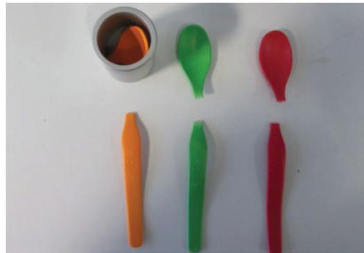
Abbildung 77 Abgebrochene Löffelköpfe und Prüfzylinder
